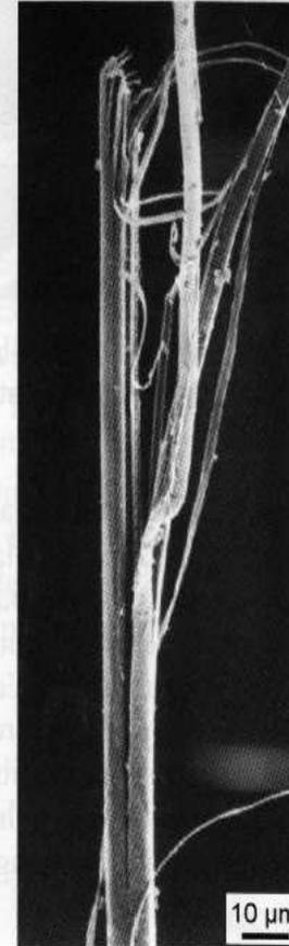
Figure 1.12 – Le Kevlar est anisotrope et éclate en fibrilles à la rupture.
