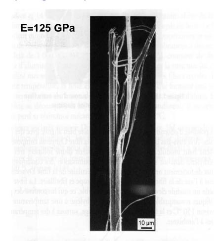
Figure 1.12 – Le Kevlar est anisotrope et éclate en fibrilles à la rupture.
