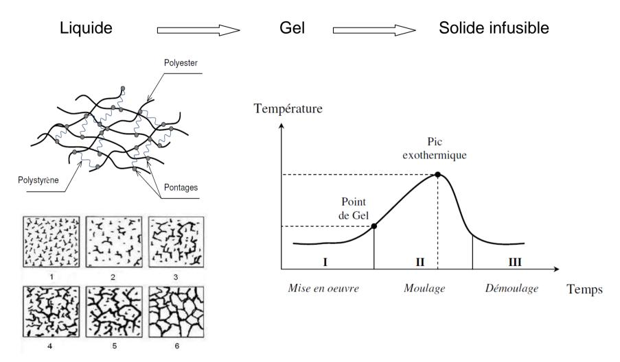
Réticulation = Formation d'un réseau tridimensionnel
