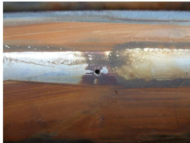
Corrosion de l'arbre sous l'hélice, sous les bagues hydrolubles et dans le tube d'étambot
